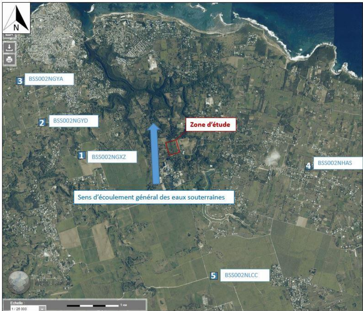
Figure 6 : Localisation des captages d'eau dans un rayon de 3km autour du site (Source : extrait d'Infoterre avec annotations BURGEAP)
